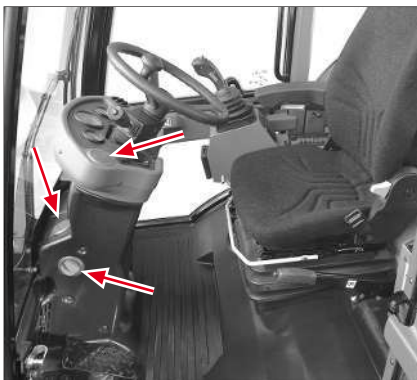
Att. 112: Ventilācijas sprauslu pārskats
