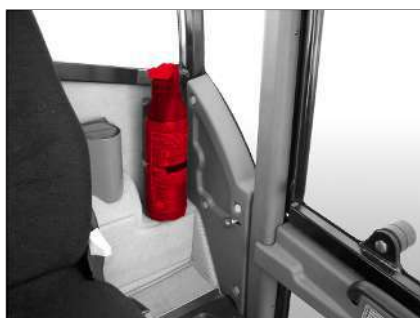
Att. 4: Ugunsdzēsamā aparāta montāžas vieta
